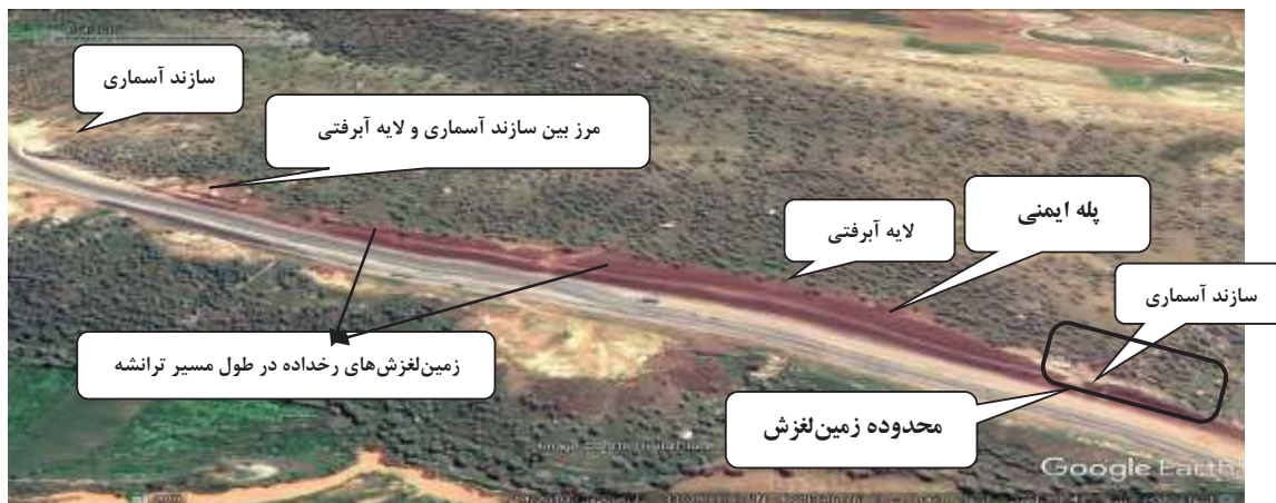
تصویر ۲: عکس هوایی سال ۲۰۱۰ از منطقه‌ی زمین لغزش، حدوداً یک سال بعد از ایجاد ترانشه
