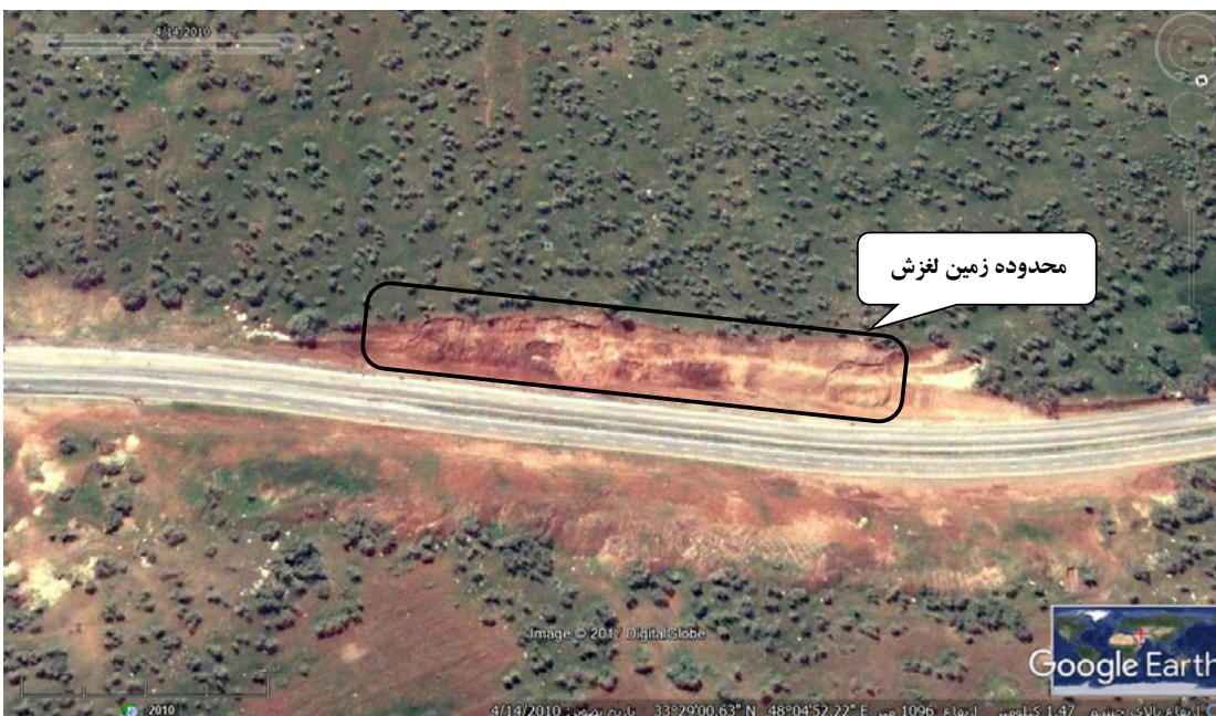
شکل ۴- عکس هوایی سال ۲۰۱۰ از منطقه زمین لغزش؛ حدود یک سال بعد از ایجاد ترانشه
