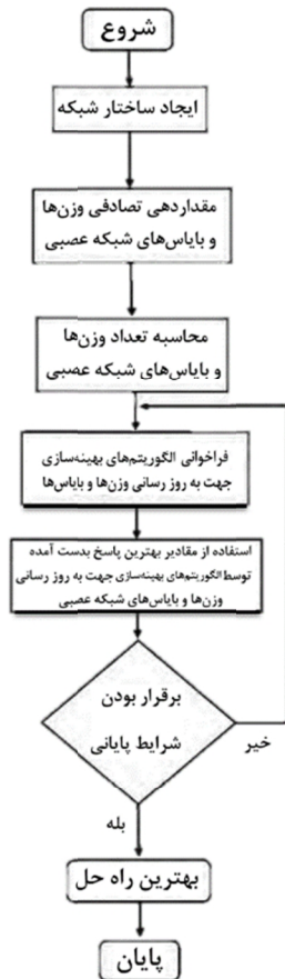
شکل ۱۷- فلوچارت بهینه‌سازی شبکه عصبی مصنوعی با استفاده از الگوریتم‌های HHO، HBA
